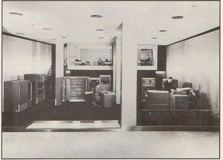
Lancé en 1952, l'ordinateur scientifique IBM 701 était doté de dérouleurs de bande magnétique et d'une mémoire centrale à tubes de Williams.
